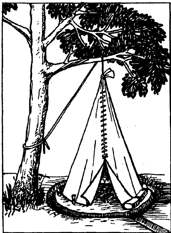
Рис. 55. Водосток вокруг укрытия.
