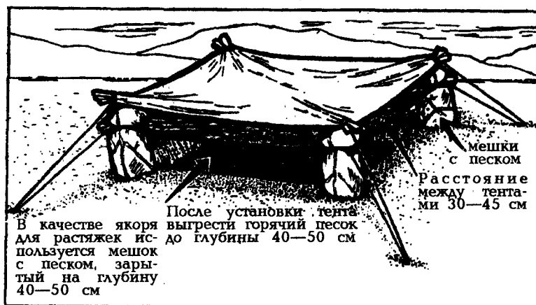
Рис. 54. Укрытие, построенное с использованием ткани и песка.
